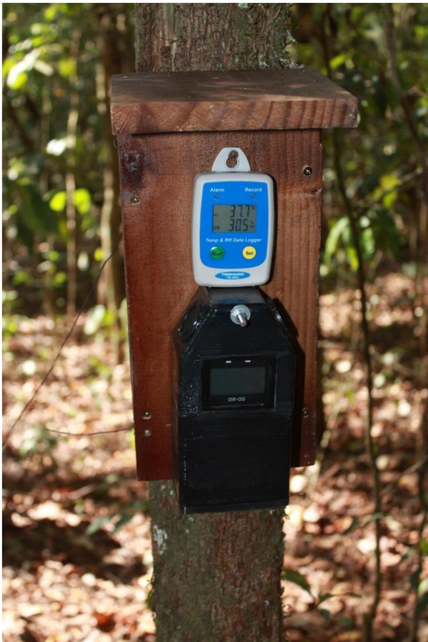
Figura 5. Dispositivo de monitoramento automatizado. (a) Áudio-Gravador Tigrinus@ GT001-T1.0V, gravadores digitais automatizados de som instalados para o monitoramento do canto da espécie; (b) *Datalogger* HM-160, registradores automáticos de dados ambientais, instalados para o monitoramento das umidades relativas do ar e as temperaturas dos microhabitats da espécie do estudo.
