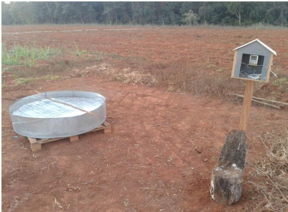
Figura 5 -Tanque Classe A e abrigo para termo-higrômetro instalado no local do experimento.
