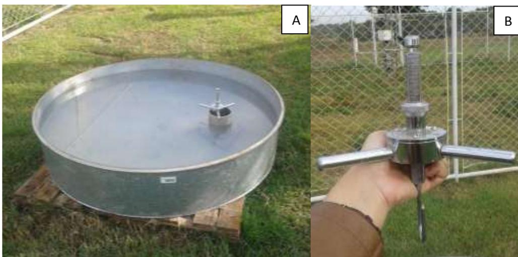
Figura 8. Tanque Classe A com micrômetro de gancho, utilizado para medir a evaporação da água, localizado na estação meteorológica do IF Goiano - Campus Ceres, 2016.
