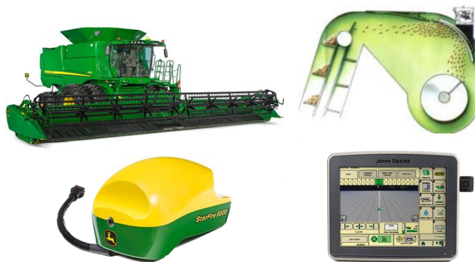
Figura 3. Colhedora de grãos; sensor de impacto; receptor de sinal de GPS; monitor de operações. (Fontes: John Deere 2017; Morgan 1998)
