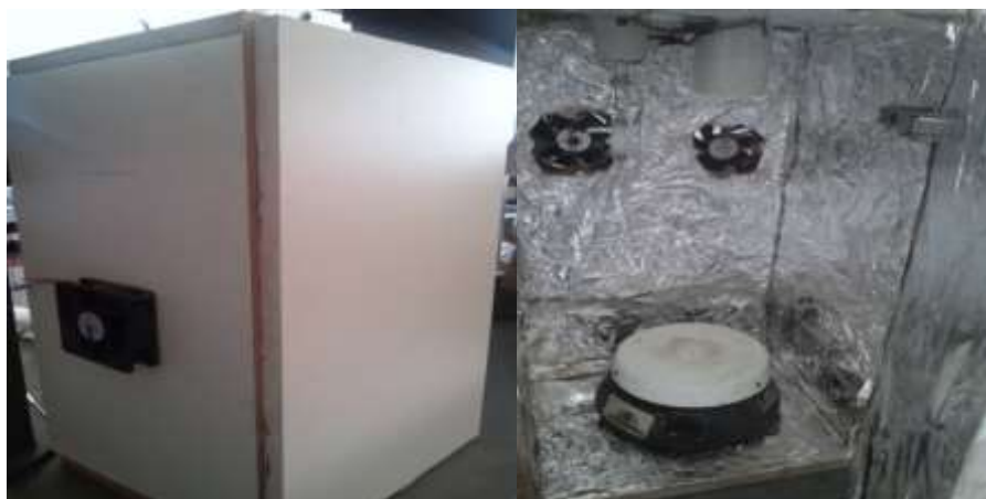
Figura 1. Câmara de fotorreação equipada com uma lâmpada de vapor de mercúrio 125 Watts, um agitador magnético e coolers para resfriamento
