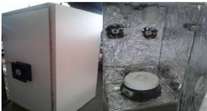
Figura 2. Câmara de fotorreação equipada com uma lâmpada de vapor de mercúrio 125 Watts, um agitador magnético e coolers para resfriamento
