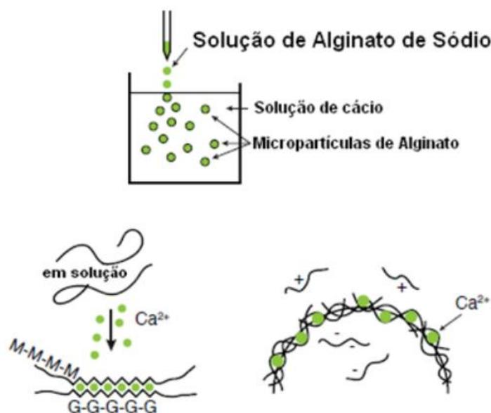
**Figura 6-** Esquema de formação das micropartículas de alginato via técnica de gelificação iônica.
