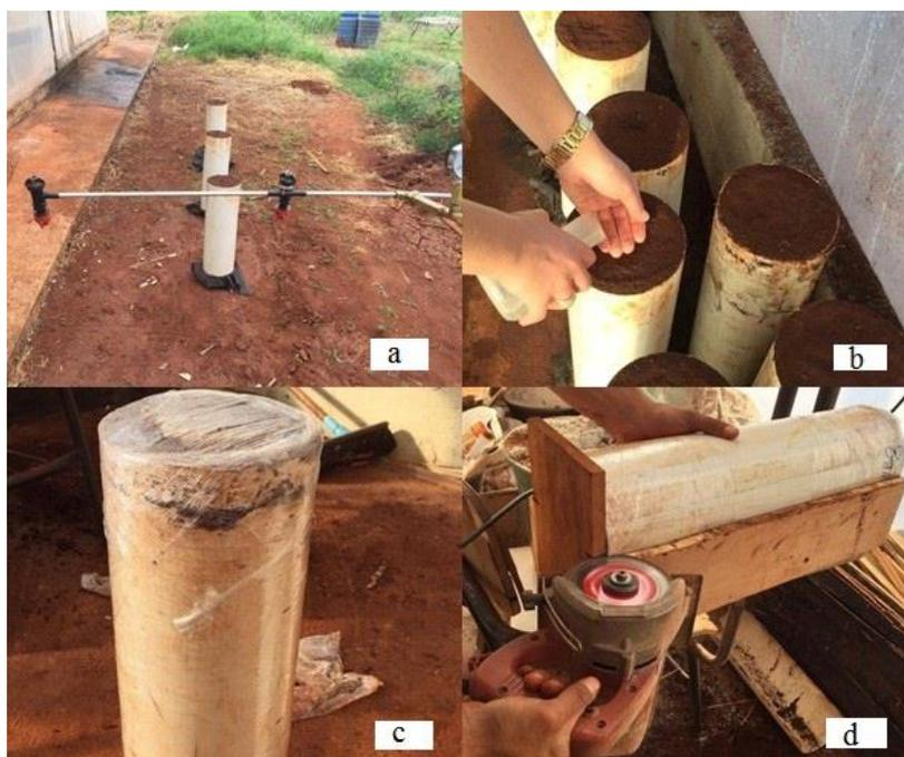
**Figura 1.** Aparato experimental utilizado para os testes de fitotoxicidade utilizando plantas bioindicadoras (a) herbicida pulverizado de maneira convencional (b) irrigação artificial durante o período de 2 meses (c e d) corte das colunas de PVC.
