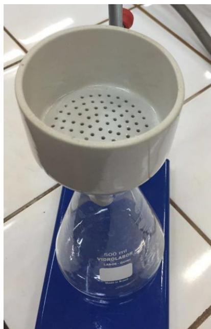
**Figura 4.** Aparato utilizado para filtrar as micropartículas de alginato de cálcio.
