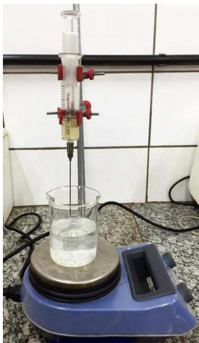
**Figura 3.** Aparato utilizado para a produção de micropartículas de alginato por gotejamento.
