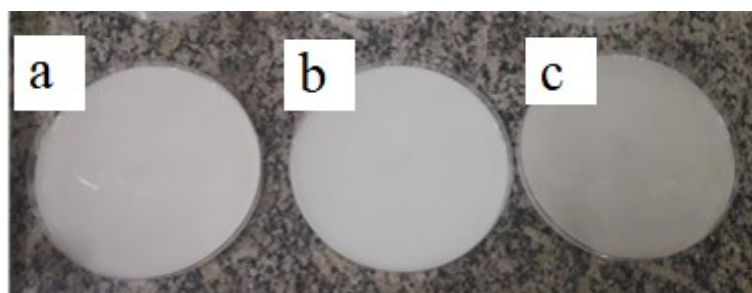
Figura 5 - Filmes de pectina cítrica adicionados com nanopartículas de zinco. a) Filme controle b) Filme com 0,2 g de nanopartículas de zinco e c) Filme com 0,4 g de nanopartículas de zinco
