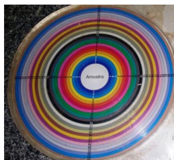
Figura 4 - Disco para a avaliação de derretimento de sorvetes, onde cada círculo corresponde a um minuto
